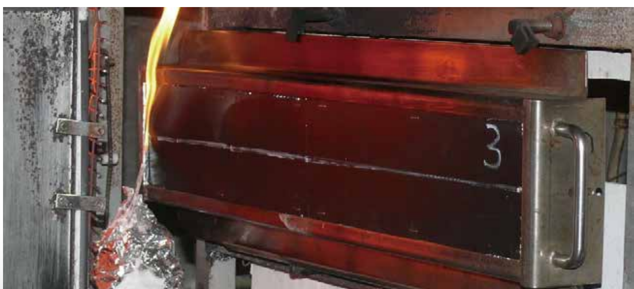
船舶向けゴム部品の難燃性試験の様子
